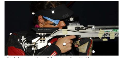
Abb.2: Sensorgewehr zur Erfassung von Kontaktkräften an Schulterkappe, Backenauflage, Griff und Handauflage
