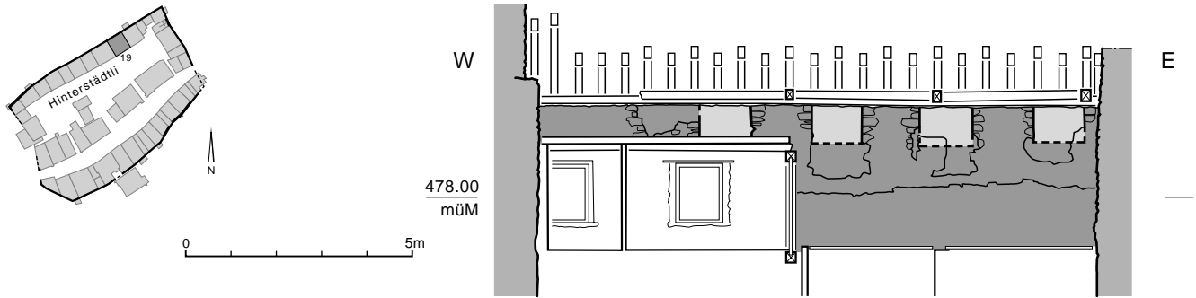
Abb. 16: Hinterstättli 19: Innenseite der Stadtmauer mit Zinnenkranz, Blick nach Norden (vgl. Abb. 63). M. 1:150.
