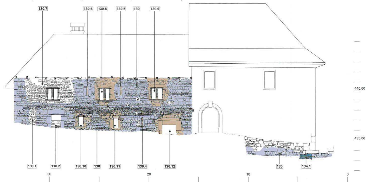
Abb. 265: Steingerechter Befundplan Westflügel, Westfassade. M 1:200.
