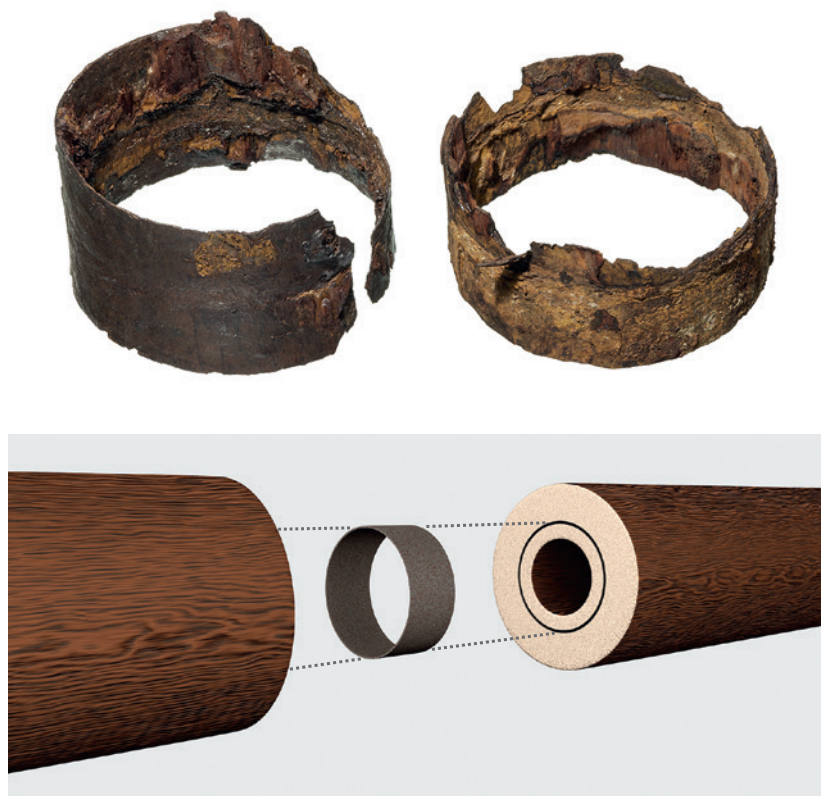
Fig. 170 : Court, Pâturage de l'Envers. Frettes cat. 2116 et ind. 6721 avec restes ligneux. Elles ont servi de jonction entre des sections de tuyaux en bois canalisant une source. Ech. 1:2.
