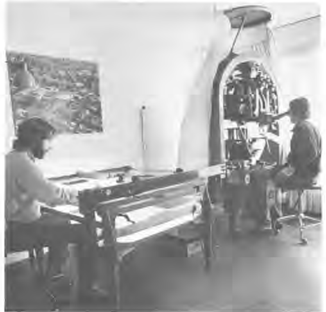
Fig. 5: Autographe servant à exploiter le système photogrammétrique. L'opérateur de droite, à l'aide de trois volants fait circuler un point mobile sur le terrain qu'il voit en relief grâce à l'appareil stéréoscopique. Le cheminement de ce point est mécaniquement retransmis sur la table de gauche, où se dessinent les objets contournés ou les courbes de niveau. L'opérateur de gauche note les altitudes que lui indique son collaborateur. A Douanne, pour les caissons 8 à 14, les plans ainsi dessinés ont pu être vérifiés sur la fouille après un délai de deux jours.
