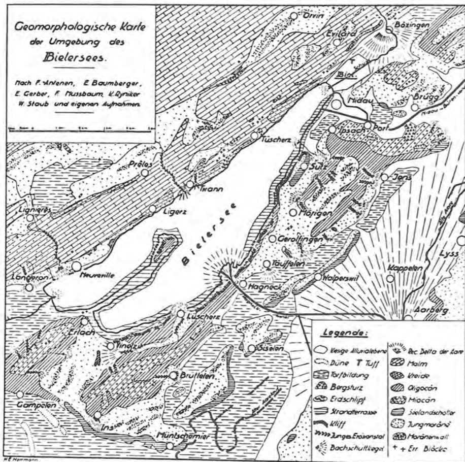
Planche 1A: Carte géomorphologique de la périphérie du lac de Biene. Junges Erosionstal = jeune vallée d'érosion, Bachschuttkegel = cônes de déjection fluvial, Malm = malm, Kreide = crétacé, Jungmoräne = moraine du pléistocène supérieur.
