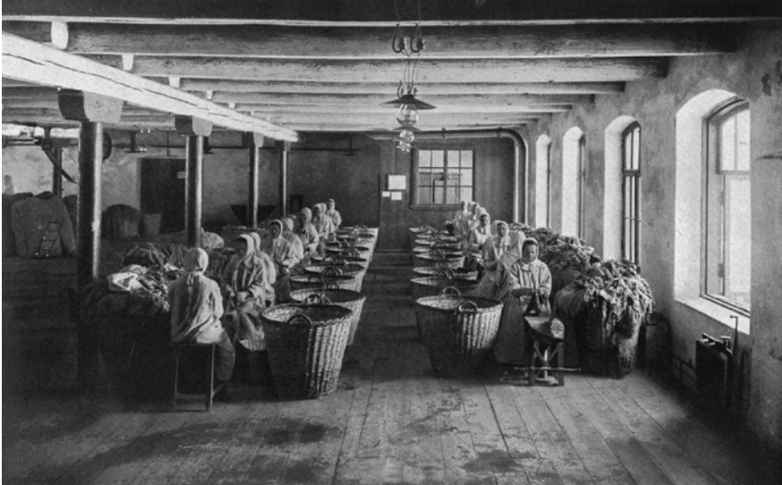
Abb. 22 o. A.: Lumpenabteilung. Abtrennen von Hand (Trjapičnoe otdelenie. Ručnaja rezka trja'ja), in: o. A.: Gesellschaft der Krasnosel'sker Papierfabrik der Erben von K. P. Pečatkin (Tovariščestvo Krasnosel'skoj pisučebymažnoj fabriki naslednikov K. P. Pečatkina), Sankt-Peterburg nach 1911, S. 9. RNB OĖ Ė((AlTch450)/(1-1a))
