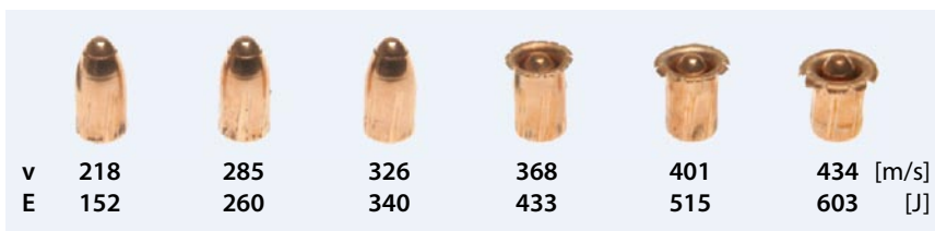
Abb. 4 Seca: Abhängigkeit der Geschossdeformation von der Auftreffgeschwindigkeit bzw. der Auftreffenergie
