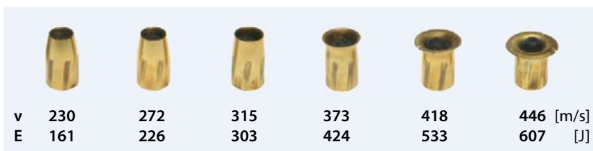
Abb. 5 Action 5: Abhängigkeit der Geschossdeformation von der Auftreffgeschwindigkeit bzw. der Auftreffenergie
