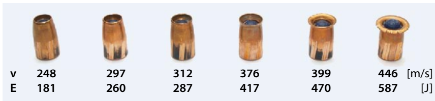
Abb. 3 QD P.E.P. II: Abhängigkeit der Geschossdeformation von der Auftreffgeschwindigkeit bzw. der Auftreffenergie
