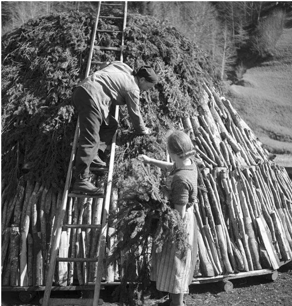
Abb. 30. Der Kohlemeiler wird mit Tannenzweigen gedeckt, Entlebuch (LU) 1940. Foto Ernst Brunner, Schweizerisches Institut für Volkskunde, Basel.
