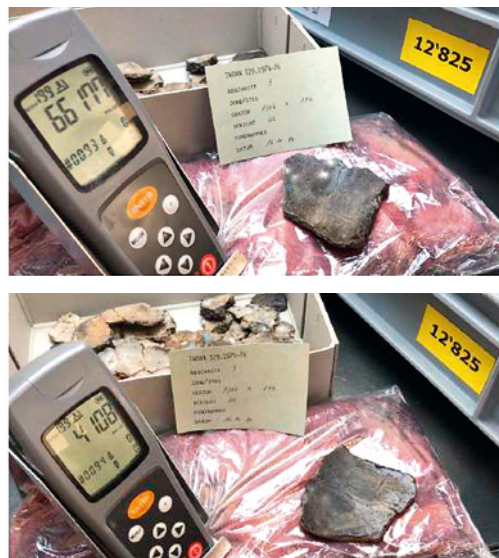
Abb. 4: Beispiel für Vergleichsmessung vor und nach der Dekontamination: Die Restkontamination beträgt danach 6,21 % des Vorzustands (Reduktion um 93,79 %).
