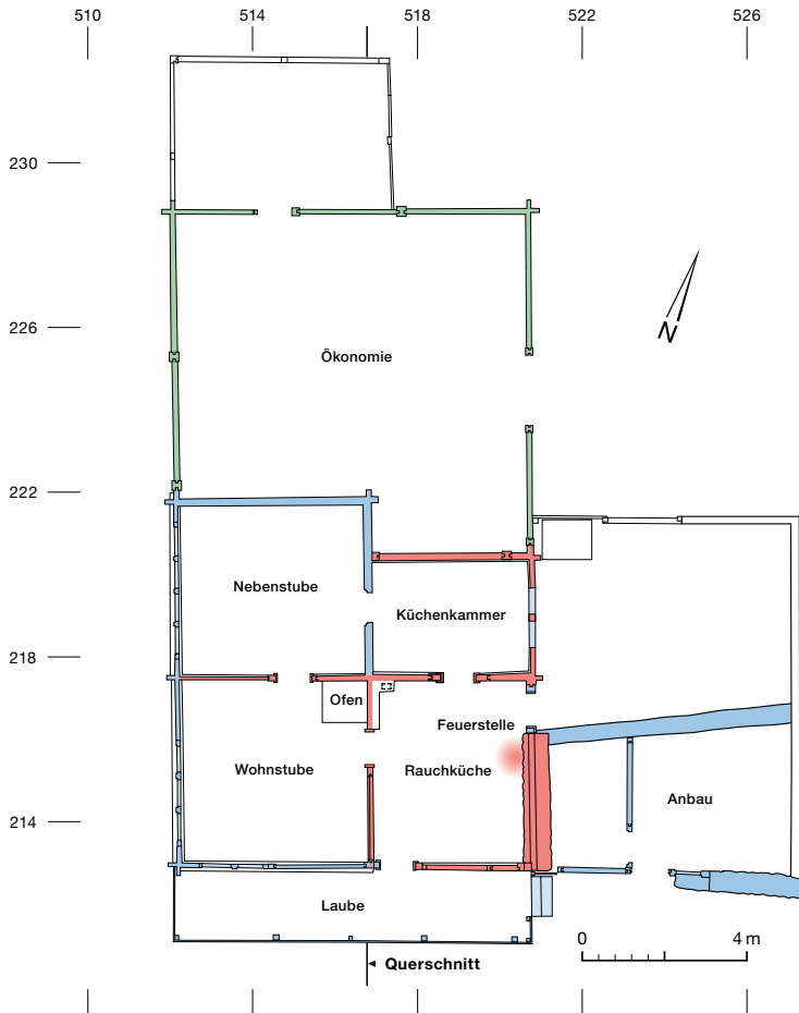
Abb. 4: Aeschi b. Spiez, Suldhaltenstrasse 31. Grundrissplan zum Erdgeschoss. Gut zu erkennen ist die 1779 vergrösserte Nebenstube, die nach Norden in die Ökonomie vorspringt. M. 1:200.
