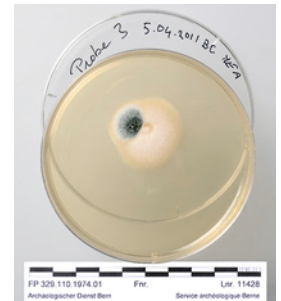
Abb. 3: Pilzkultur einer Probe in einer Petrischale, mit der während der Vorversuche der Erfolg der Reinigung bewertet wurde.
