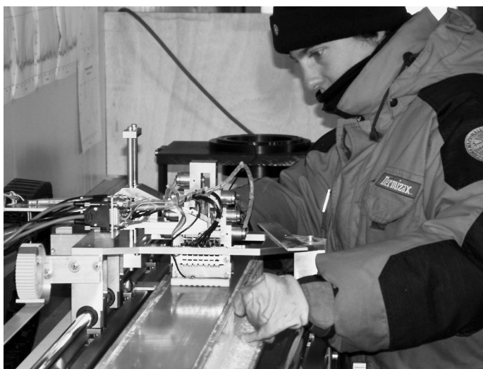
Abb. 3: Leitfähigkeitsmessung am Eisbohrkern durch Jacqueline Flückiger.
