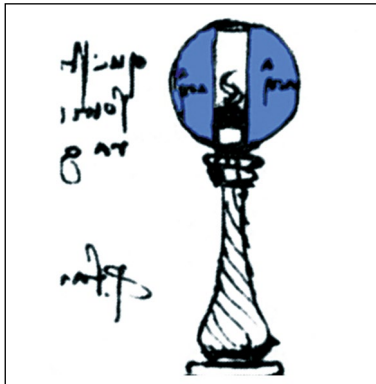
Abbildung 3. Kerzenlampe von Leonardo da Vinci, blaue Einfärbung des Lichtes mittels Lackmus.
