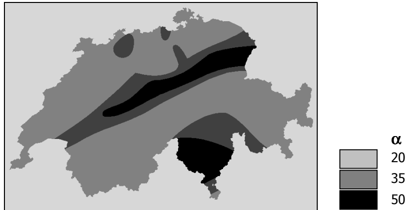
Abbildung 3.9: Zonenkarte für die \alpha -Werte nach Zeller.
