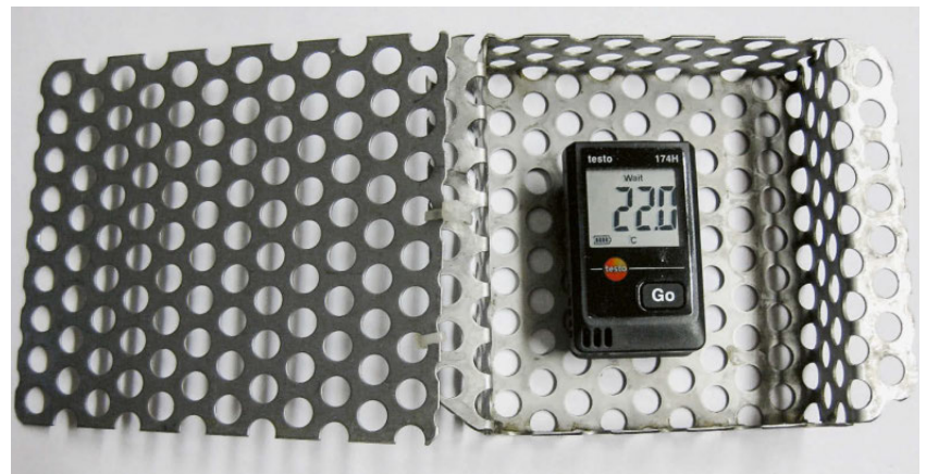
Abbildung 1: Datenlogger (Testo 174H Mini-Datenlogger, Testo AG, 8617 Mönchaldorf, Schweiz) für die kontinuierlichen Temperatur- und Luftfeuchtigkeitsmessungen. Der Datenlogger wurde durch eine Metallbox vor den Kälbern geschützt.
