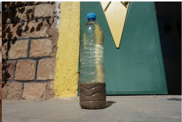
Figure 23: Eau de l'Oued Outat sédimentée, collectée après un orage. Plus d'un quart du liquide est composée de boues qui engorgeront les barrages (Stefan Graf)
