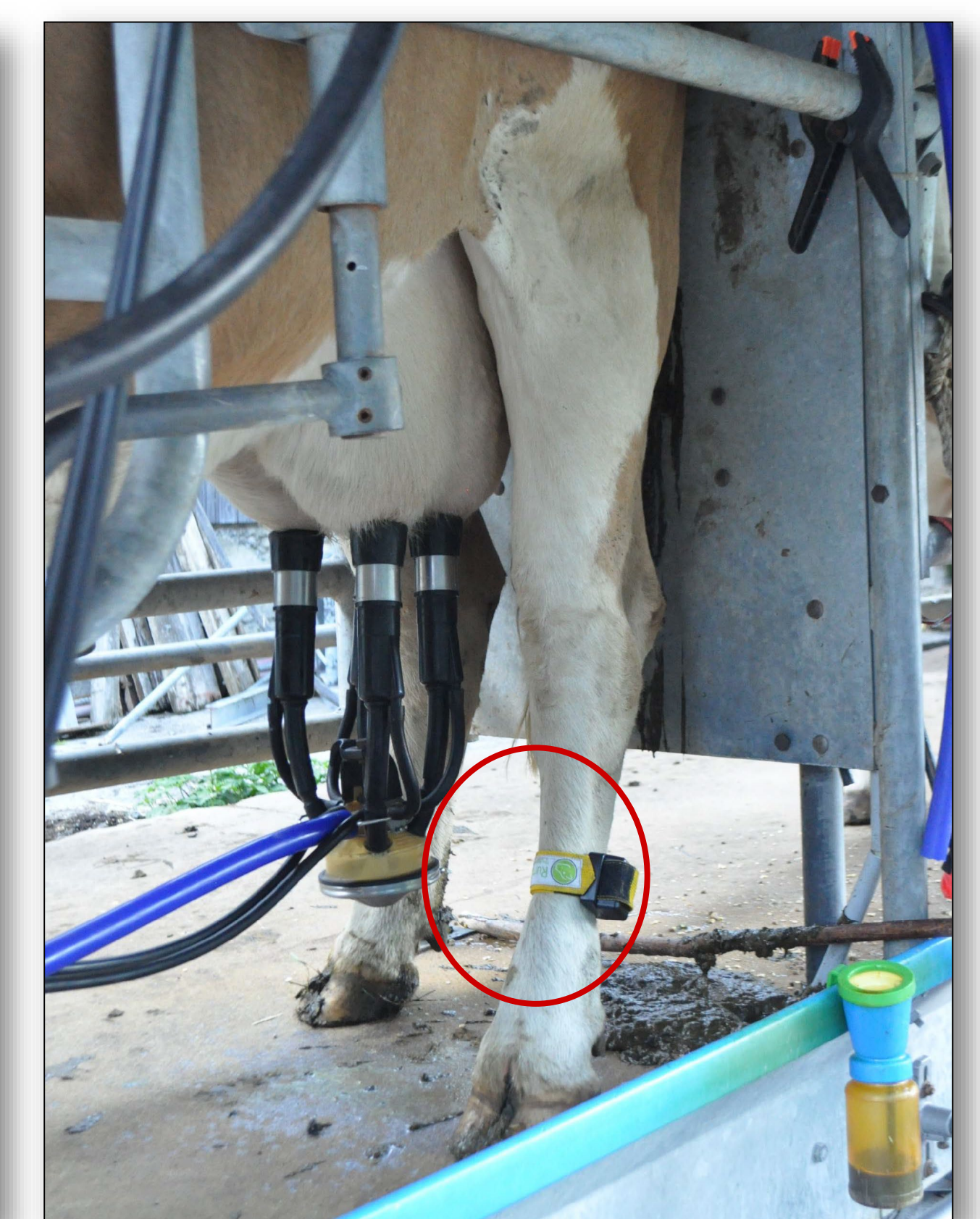
3D Accelerometer (RumiWatch®, ITIN+HOCH GmbH, Schweiz)
