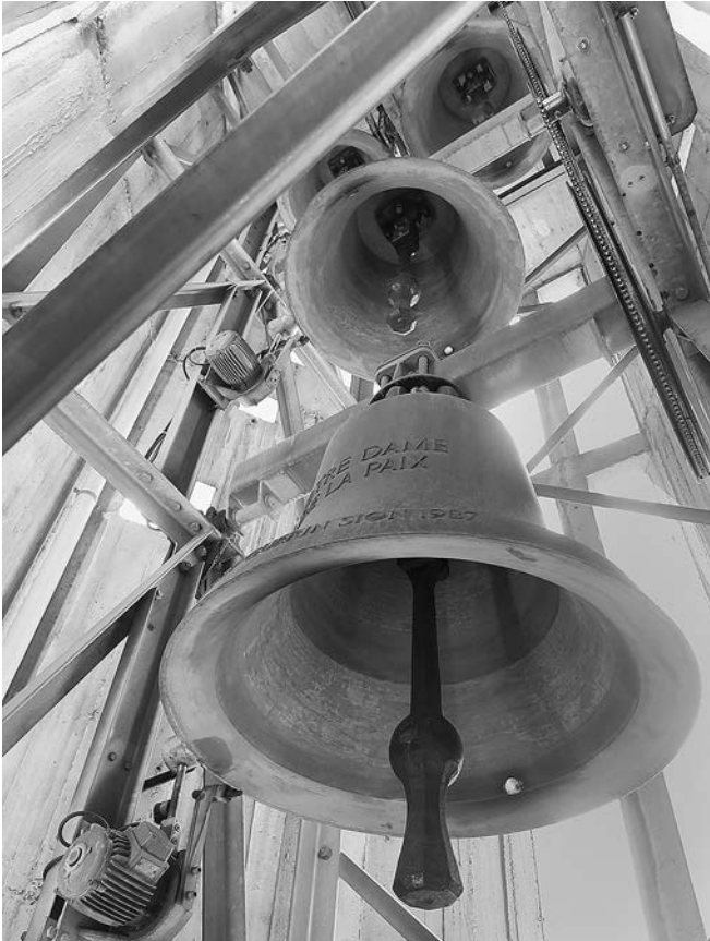
Abb. 42: Typische schweizerische Klöppelinstallation des 20. Jahrhunderts: Unter den Anschlagballen lange und ausgreifende, sogenannte Vorschwünge, einen peitschend-obertönigen Klang verursachen.
