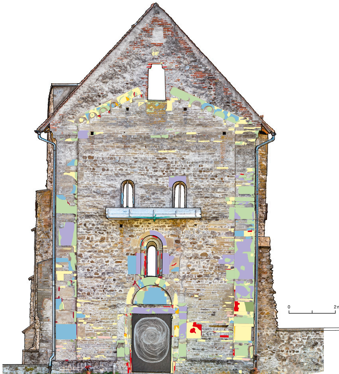
15 Rüeggisberg, Kloster. Nordfassade des Querhauses mit Kartierung der verschiedenen Schadens-typen vor der Restaurierung. Planaufnahme von 2019. M. 1:100.
