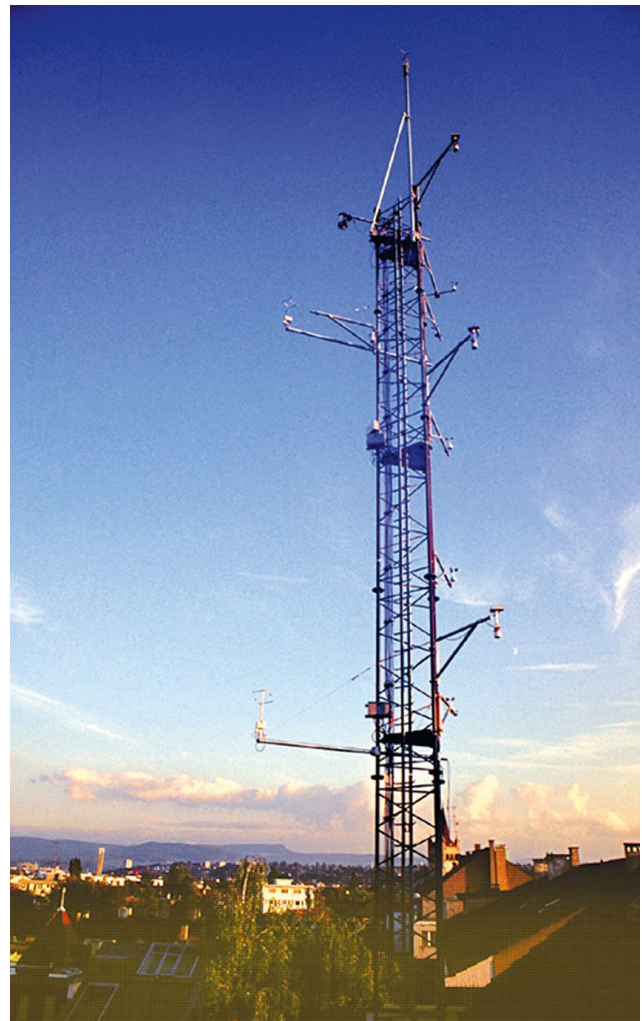
Abbildung 12-8: Messturm auf dem Dach des ehemaligen Meteorologischen Instituts der Universität Basel, ausgestattet mit einer Vielzahl meteorologischer Messgeräte auf unterschiedlichen Höhen zur Untersuchung der vertikalen Turbulenzprozesse in der Stadthindernisschicht. Die Daten fanden unter anderem im BUBBLE-Projekt Anwendung (ROTACH et al. 2005; Foto: https://www.mcr.unibas.ch/dolueg2/projects/campaigns/BUBBLE/textpages/ov_frameset.en.htm ).
