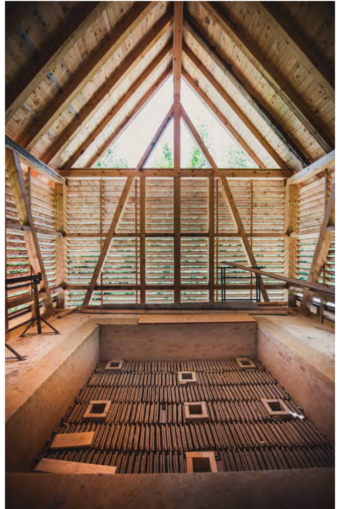
25 Freilichtmuseum der Schweiz, Ziegelei aus Péry: Blick auf den fertig eingeräumten Brennofen. Die quadratischen Öffnungen dienen als Züge des Ofens während des Brands. Anschliessend wurde das Brennmaterial mit Ausschussziegeln und Erde abgedeckt, um die Hitze im Ofen optimal zu halten. Blick nach Norden. Aufnahme 2022.
