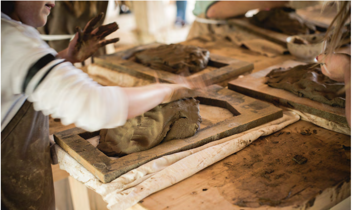
15 Freilichtmuseum der Schweiz, Ziegelei aus Péry: Wie im 18./19. Jahrhundert werden noch heute in der Museumsziegelei die Grünlinge gefertigt. Traditionelles Schlagen handgestrichener Ziegel in Holzrahmen eines Schulprojekts im Museum 2021. Die handgestrichenen Ziegel wurden anschliessend 2022 im wiederaufgebauten Ziegelofen in handwerklicher Manier mit Erfolg gebrannt. Aufnahme 2021.
