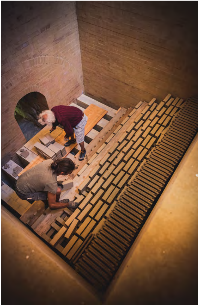
24 Freilichtmuseum der Schweiz, Ziegelei aus Péry: Einschichten der Ziegelrohlinge zum Brennen im Ofen. Wichtig ist das akkurate Aufstellen der Grünlinge, um eine gleichmässige Verteilung der Hitze im Ofen zu gewährleisten. Blick nach Südwesten. Aufnahme 2022.
