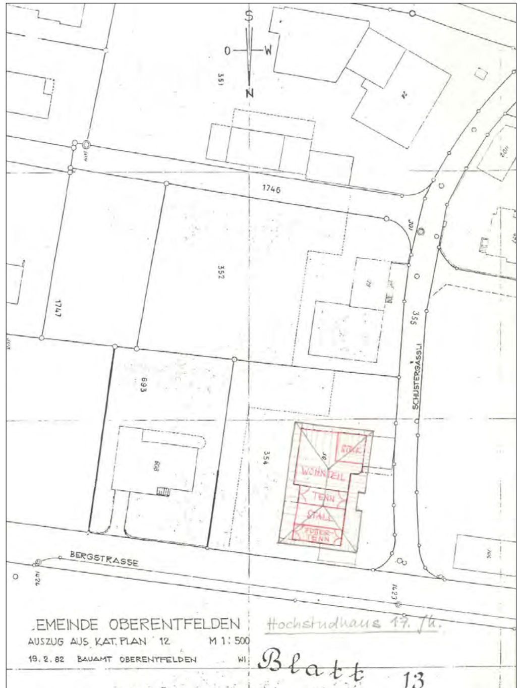
9 Oberentfelden, Schustergässli 1/3: Ausschnitt des Katasterplans mit dem darauf eingetragenen Bauernhaus und dessen Grundrissgliederung. Auffällig ist die strassenseitige Orientierung des Stall- und Ökonomieteils. Der ehemals nicht durch einen Anbau verstellte gemauerte Stock war allerdings ebenso repräsentativ zur Strasse gewendet, während die anderen Teile des Wohnteils zur Gartenseite zeigen. Ausrichtung nach Süden. Aufnahme 1982.
