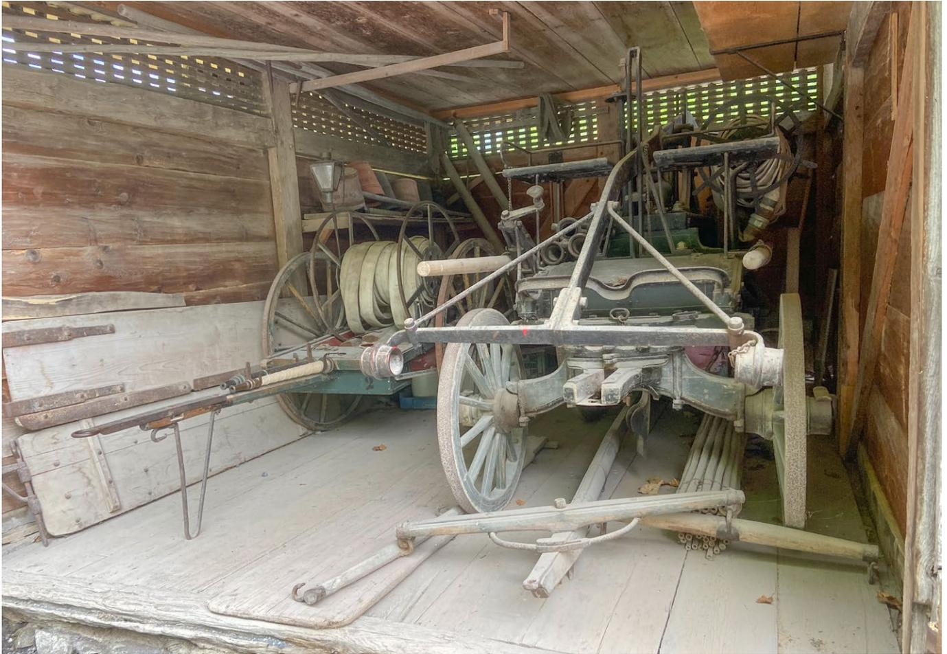
4 Freilichtmuseum der Schweiz, Spritzenhaus aus Mühledorf: Blick in das Spritzenhaus, das mit typischen Löscheräten der Zeit um 1900 ausgestattet ist. Neben dem Schlauchwagen links und einem Spritzenwagen aus Rüeggisberg BE von 1902 sind links auf dem Regal Löscheimer aus Leder und unter der Decke Feuerhaken mit langen Holzstangen zu sehen. Die Eimer waren ursprünglich Privatbesitz und wurden bei den jeweiligen Dorfbewohnern zuhause gelagert. Blick nach Süden. Aufnahme 2022.
