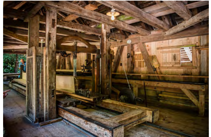
18 Freilichtmuseum der Schweiz, Sägemühle aus Rafz: Die historische Einfachgattersäge aus Elgg in Betrieb. Das während der Saison geschnittene Holz wird im Freilichtmuseum weiterverwendet. Blick nach Südosten. Aufnahme 2020.
