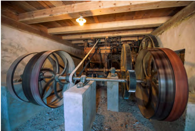
17 Freilichtmuseum der Schweiz, Sägemühle aus Rafz: Da der Unterbau der Sägemühle am ehemaligen Standort in Rafz fehlte, wurde dieser im Freilichtmuseum vollständig rekonstruiert. Nun beherbergt er den historischen Antriebsmechanismus für das aus Elgg ZH stammende Sägegatter und die Wagenfräse. Blick nach Osten. Aufnahme 2020.
