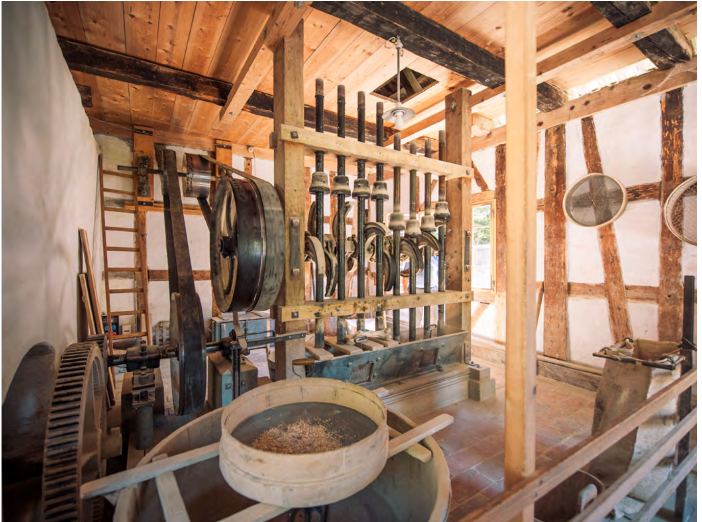
18 Freilichtmuseum der Schweiz, Knochenstampfe aus Knonau: In die Gebäudehülle aus Knonau wurde eine historische Stampfanlage aus Heimisbach BE eingebaut, wohl ergänzt um Bestandteile einer Anlage aus Alpnachstad OW. Durch die dreifache Übersetzung aus Zahnrädern und Treibriemen dreht sich die Nockenwelle deutlich schneller als das Wasserrad. Bis die Knochen von den Stößeln zu feinem Mehl zerstampft werden, vergeht dennoch viel Zeit. Blick nach Südosten. Aufnahme 2020.
