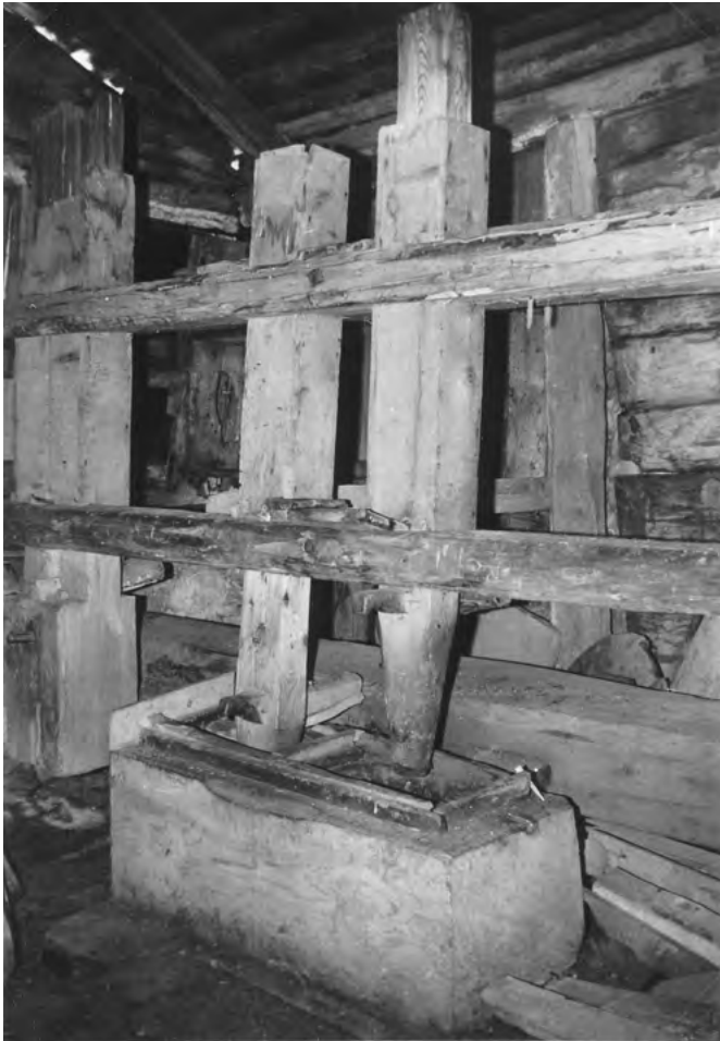
15 Medel, Fuorns: Die Stampfanlage bestand aus drei Stampfgängen, einem für das Brechen von Flachs, links zu sehen und zwei für das Zerstampfen der Leinsaat zu Mehl und Paste, rechts davon. Der Stampftrog bestand aus einem mächtigen ausgehöhlten Holzklotz. Aufnahme ca. 1978.
