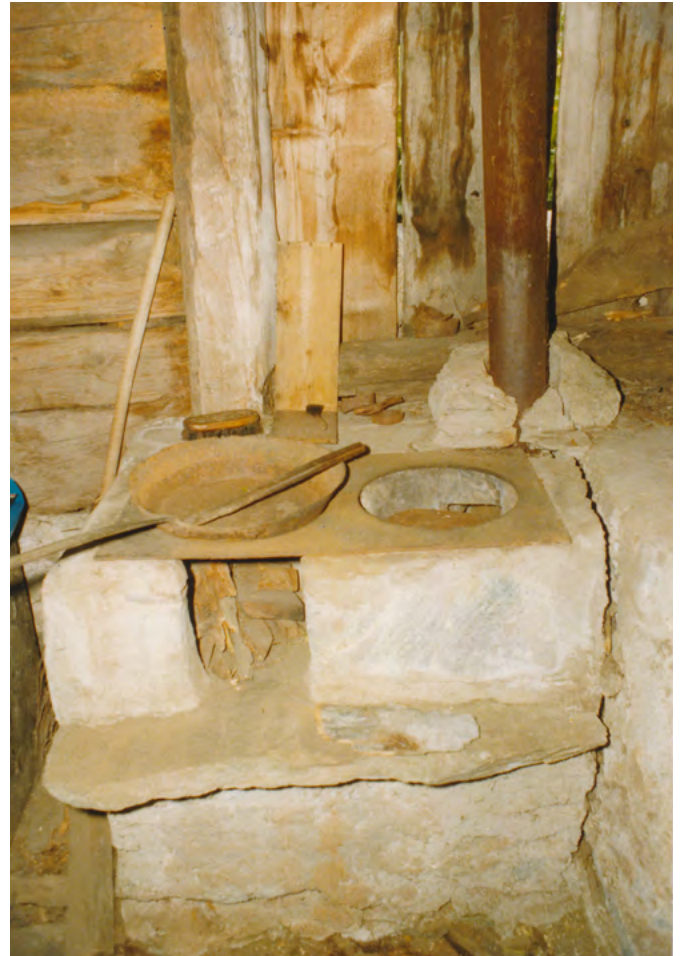
16 Medel, Fuorns: Auf diesem einfachen Herd wurde die Leinsamenpaste geröstet, bevor sie in die Ölpresse kam. Warme Leinsaat gibt mehr Öl ab als kalte. Dafür galt kaltgepresstes Öl ohne vorangehende Erhitzung als wertvoller, wenn auch weniger ergiebig und wurde vor allem für medizinische Zwecke bei Mensch und Tier eingesetzt. Aufnahme ca. 1978.
