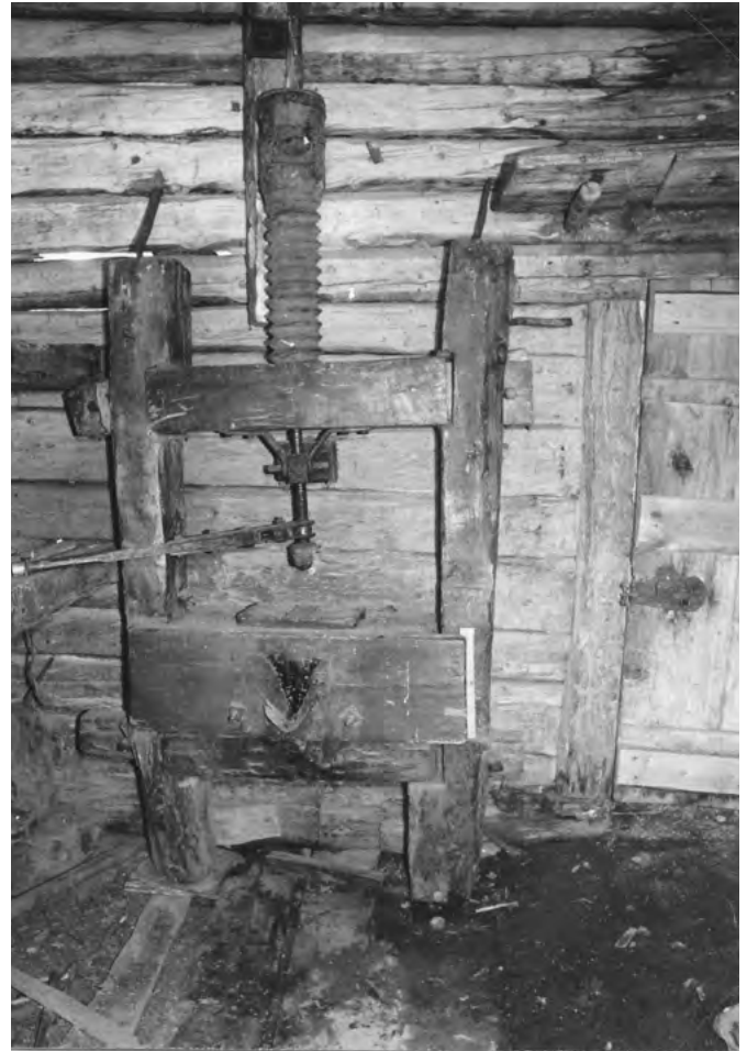
14 Medel, Fuorns: Die Spindelpresse zur Ölgewinnung. Die Konstruktion musste beim Pressvorgang beachtlichen Druckkräften standhalten und war daher aus mächtigen Holzbalken angefertigt. Die ursprünglich hölzerne Spindel wurde bei der Begehung in der Stampfe entdeckt. Sie war durch eine metallene Spindel ausgetauscht worden. Blick nach Norden. Aufnahme ca. 1978.
