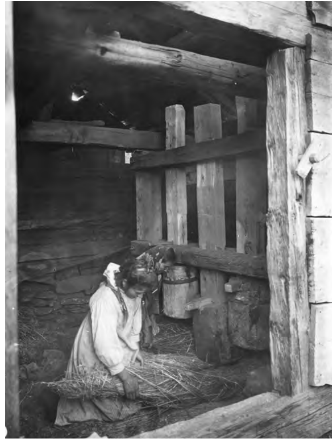
8 Tujetsch, Rueras: Eine reine Flachs- und Hanfpoche. Oftmals waren die Stampfen für die Stängel und die Samen in einer Anlage untergebracht. Beim Brechen des Flachses und Hanfs wurden die zu Garben gebundenen Pflanzenstängel unter den Stampffuss gelegt und immer wieder gewendet, damit sich die wertvollen Pflanzenfasern von den harten Bestandteilen lösten. Es handelte sich dabei um eine äusserst staubintensive Arbeit. Aufnahme ca. 1917.
