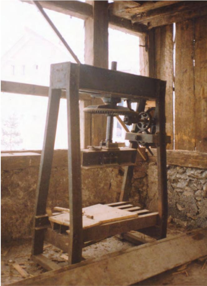
**13** Meggen, Hof Weid: In der Scheune befanden sich noch Teile von der früheren Einrichtung als Mosterei. Dazu zählten neben je einem Trichter in den Böden des Dach- und Obergeschosses auch die abgebildete Mostpresse und eine Transmissionswelle im Erdgeschoss. Blick nach Südosten. Aufnahme undatiert.
