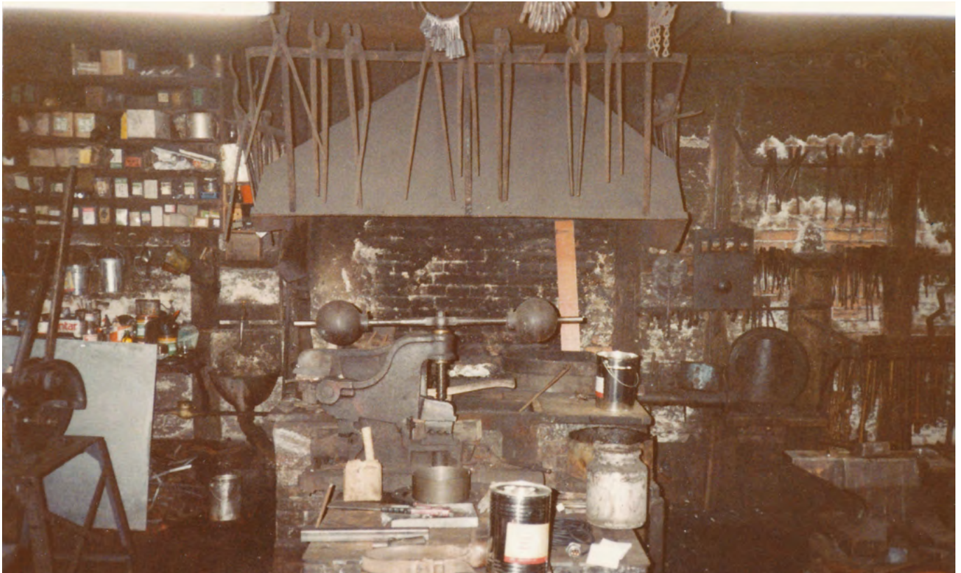
12 Bümpliz, Hufschmiede Bachmätteli: Ausstattung der Schmiede von Robert Kislig. Im Hintergrund ist die Schmiedeesse mit der Blechhutte zu sehen, in der Mitte davor steht das grosse Schneidgewinde mit den beiden Eisenkugeln. Aufnahme um 1983.
