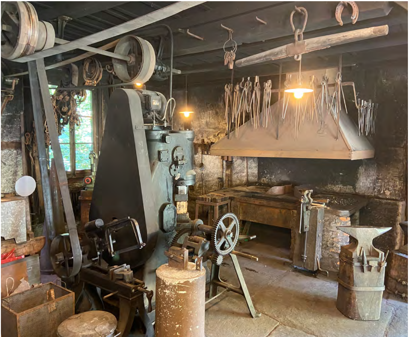
26 Freilichtmuseum der Schweiz, Schmiede aus Bümpliz: Die heutige Werkstatt ist im Vergleich zur Bümplizer Schmiede modern ausgestattet. Sie verfügt nun unter anderem auch über eine Esse mit Elektrogebläse und einen schweren Presslufthammer. Blick nach Südwesten. Aufnahme 2021.
