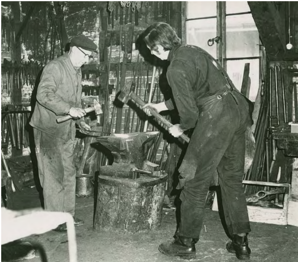
11 Bümpliz, Hufschmiede Bachmätteli: Vater und Sohn Kislig bei der Arbeit am doppelhörigen Amboss. Charakteristisch ist in der traditionellen Schmiede die reiche Ausstattung mit einer Vielzahl an Zangen und Hämmern. Aufnahme um 1969.
