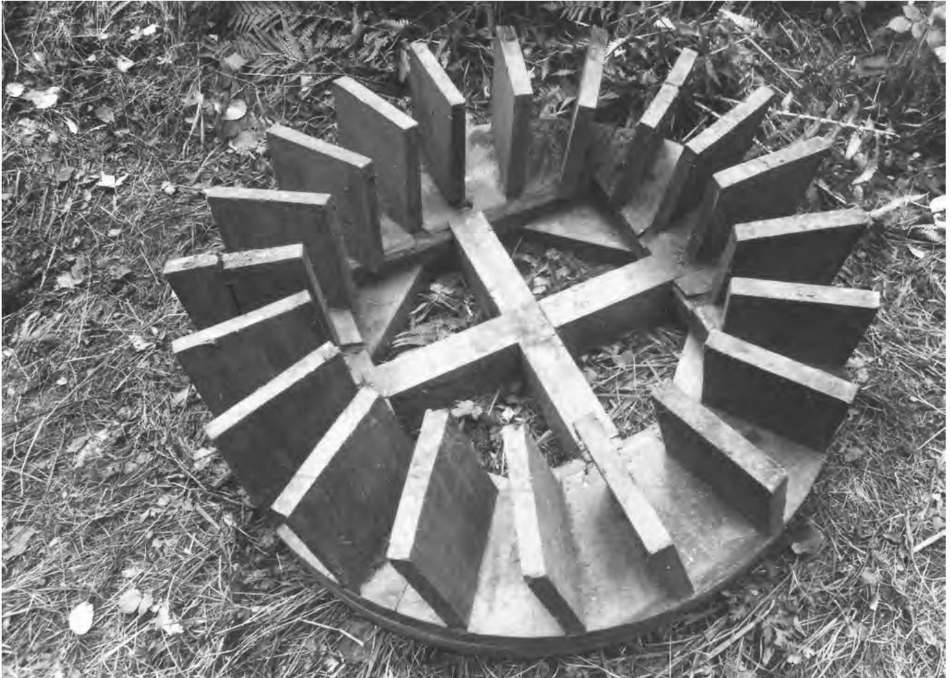
9 Törbelbach: Eines der Wasserräder aus der unteren der beiden abgetragenen Mühlen. Es wurde in die wiederaufgebaute Mühle auf dem Ballenberg integriert. Eine Besonderheit stellen die auf einem Ring angeordneten Schaufeln dar. Meist waren die Schaufeln bei horizontalen Wasserrädern direkt in die Nabe des Wellbaums eingenuet. Aufnahme 1984.
