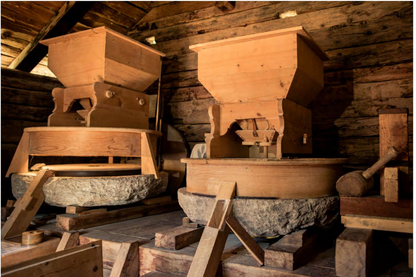
**14** Freilichtmuseum der Schweiz, Mühle aus Törbel: Die Mahlstühle im Obergeschoss wurden einschliesslich Rüttelwerk, Mehlkästen und Sichtersystem, ebenfalls rekonstruiert. Drei Mahlsteine wurden aus der alten Mühle wiederverwendet, ein vierter, fehlender Stein stammt aus dem ehemaligen Nachbargebäude. Aufnahme 2017.
