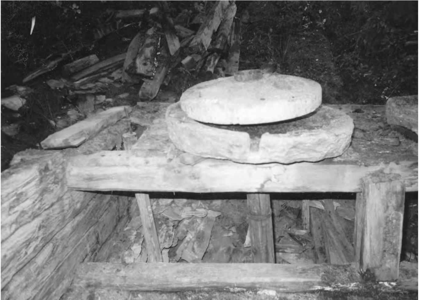
8 Törbelbach: Der linke Mahlgang der oberen und später auf den Ballenberg translozierten Mühle. Er diente vermutlich nicht der Herstellung von Mehl, sondern als Rellgang, der das Korn schälte und entspelzte. Dies war bei jenen Getreidearten nötig, die nicht bereits beim Dreschen die Schale verloren. Aufnahme 1984.
