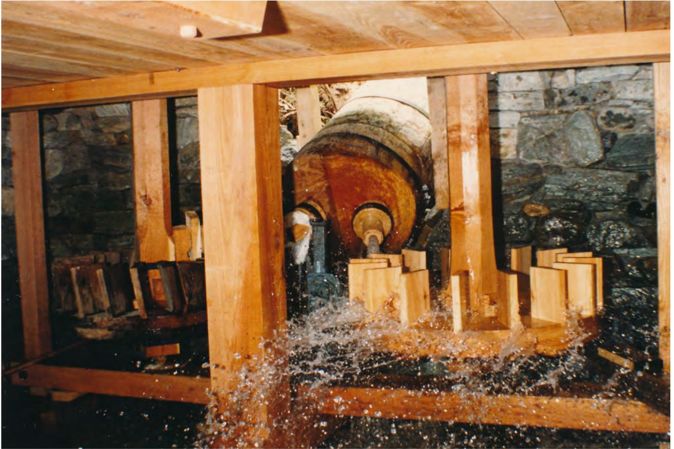
**13** Freilichtmuseum der Schweiz, Mühle aus Törbel: Da fast die gesamte technische Ausstattung der Mühle beschädigt und verfallen war, musste sie nahezu gänzlich rekonstruiert werden. Von der benachbarten Mühle wurde ein Wasserrad wiederverwendet, das sich aufgrund seiner dunkleren Färbung deutlich vom Neumaterial abhob. Das alte Rad musste jedoch im Museum aufgrund von Verschleiss später ebenfalls ausgetauscht werden. Aufnahme 1986.
