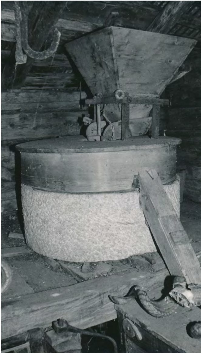
12 Naters, Mühle im Weiler Stockji: Die Mühlsteine mit Trichter und Rüttelschuh. Das über den Trichter eingefüllte Korn fiel zunächst in den Rüttelschuh, der für eine fortlaufende und gleichmässige Beigabe des Kornes zwischen die Mahlsteine sorgte. Auch hier kam ein Rüttelmechanismus zur Anwendung, wobei man sich die Drehung des Läufersteins zunutze machte. Aufnahme 1983.
