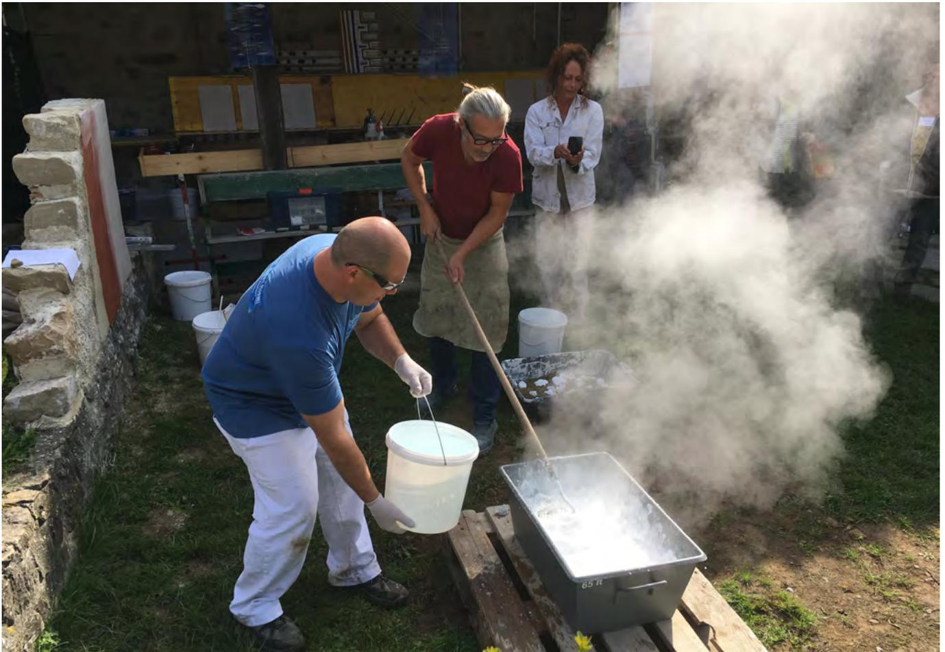
**20** Rüeggisberg BE, Klosterruine: Traditionelle Herstellung von heissgelöschtem Kalk am Tag des Denkmals. Auf dieselbe Weise wurde für den Wiederaufbau der Kapelle auch erstmalig auf dem Ballenberg gebrannter Kalk gelöst und anschliessend für den Aussenputz verwendet. Aufnahme 2018.
