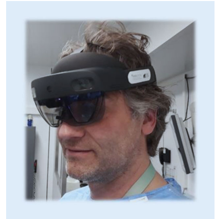
Abb. 4 ▲ HALO-Assist. Ein HALO-Assist-Support kann remote sehen, was der HALO-Assist-Provider (im Bild) vor Ort sieht, ohne dass die AR-Brille stört, selbst wenn der Operator Brillenträger ist. Support und Provider können miteinander sprechen, auch wenn es sehr laut ist, ohne dass es andere stört. HALO „high acuity low occurrence“
