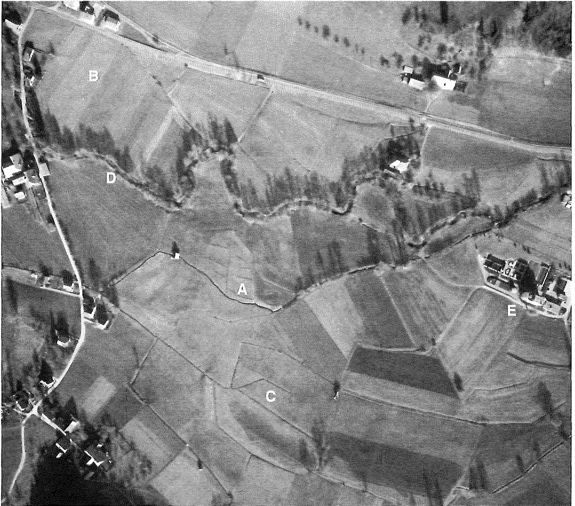
*Abb. 1: Wiesenbewässerungsgebiet im Langetal bei Rohrbach. Luftbildaufnahme vom Frühwinter 1978. A: Aktive Bewässerungsgräben, Hauptgraben mit Seitengräben und Verteilergräben. B: Aufgelassene (zugeschüttete) Bewässerungsgräben. C: Entwässerungsgräben. D: Langete. E: Abwasserreinigungsanlage Rohrbach.*
