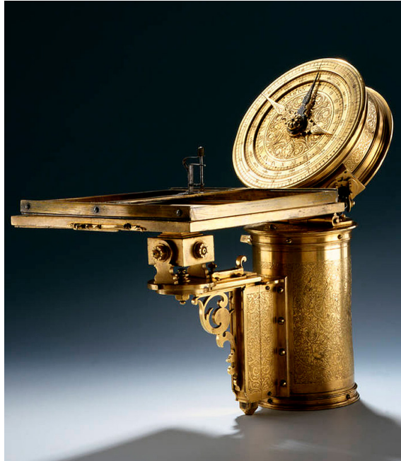
Fig. 11 Christoph Trechsler, Waywiser, 1584, brass (gilded, etched, engraved, punched), steel, total height 42 cm, total depth 38.5 cm, Staatliche Kunstsammlungen Dresden, Mathematisch-Physikalischer Salon, C III a 4
