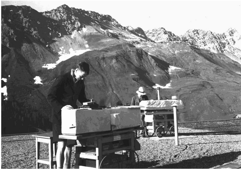
Ozonmessungen in Arosa mit Dobson-Spektrometern Anfang der 1950er-Jahre (Archiv Lichtklimatisches Observatorium).
