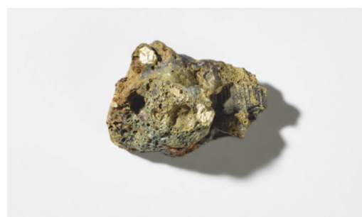
83 Wiedlisbach, Städtli 29. Beispiel für eine sandig-lehmige Kalottenschlacke, Typ 1 (SAS). M. 1:2.
