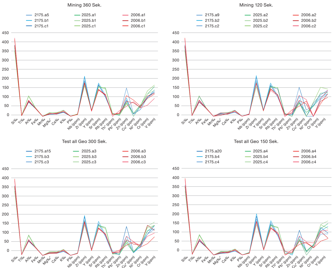
319 Evaluation der Methode (Messmodus und -zeit) zur Analyse von Schwarzgestein mit portabler Röntgenfluoreszenz (pXRF). Vergleich der in den Messmodi Mining und Test all Geo mit verschiedenen Messzeiten an neun unterschiedlichen Messpunkten erhobene Werte (jeweils drei Messpunkte an drei verschiedenen Schwarzgesteinartefakten). Anhand der sehr ähnlich verlaufenden Elementprofile ist erkennbar, dass mit den verschiedenen Messmodi und -zeiten die chemische Zusammensetzung der Elemente an den einzelnen Messpunkten sehr ähnlich erfasst wird. Zudem zeigt sich an den verschiedenen Messpunkten, dass die elementare Zusammensetzung der einzelnen Steinartefakte eine gewisse Heterogenität aufweist. Hauptelemente in Promille (‰), Spurenelemente in Millionstel (ppm). Bei den mit * gekennzeichneten Elementen liegt der gemessene Anteil nahe oder unter der Nachweisgrenze. Datengrundlage: eDat. 319.
