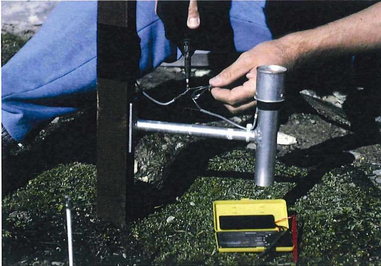
Abbildung 6: Installation eines Thermistors.
