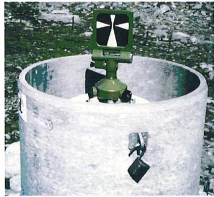
Abbildung 11: Zielmarke montiert auf Fixpunkt. (Foto: B. Krummenacher)
