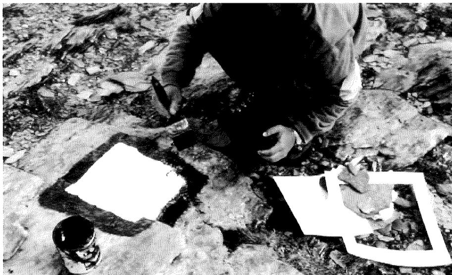
*Abbildung 13: Erstellung eines Passpunktes, das Zentrum dieser Fläche wird tachymetrisch vermessen. (Foto: B. Krummenacher)*
