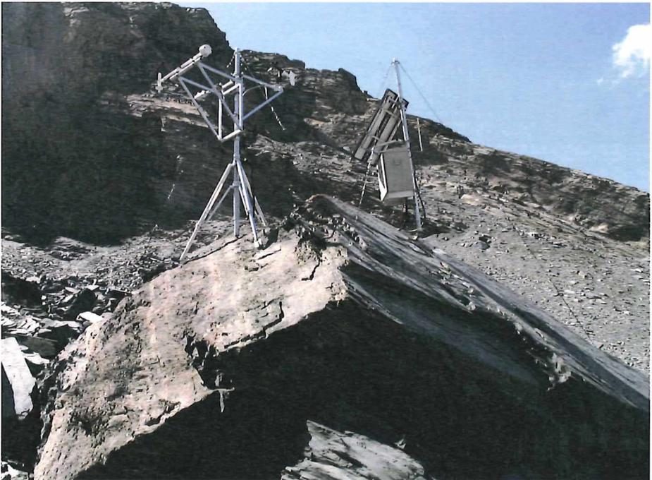
*Abbildung 25: Meteostation 2 auf dem Felsblock in der Blockgletschermittle. (Foto: A. Nussbaum)*
