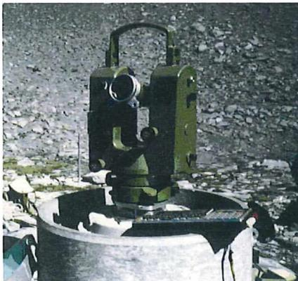
Abbildung 10: Sekundentheodolit Kern E2 montiert auf Fixpunkt 101. (Foto: B. Krummenacher)
