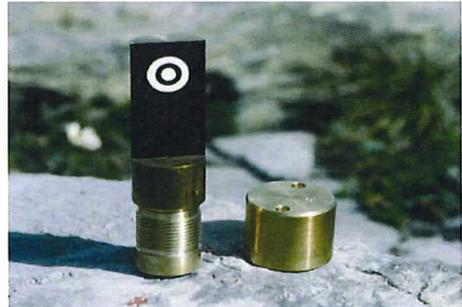
Abbildung 9: Zielpunkt auf der Solifluktionszunge, die Messingmarke ist um 360° drehbar. (Foto: B. Krummenacher)
