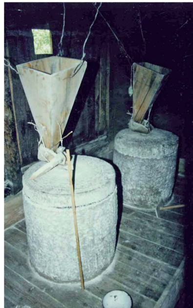
Abb. 55: Mühle mit Oberläufer im Kreis Danba (1993)
