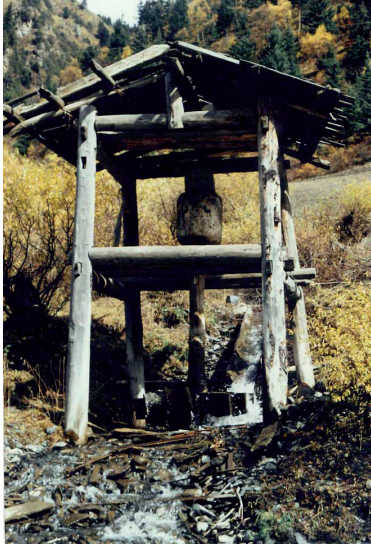
Abb. 38: wasserradgetriebene Gebetsmühle im Kreis Songpan (1995)
