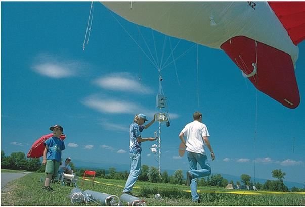
Abbildung 50: Das Sondiersystem des Geographischen Instituts der Universität Bern mit dem 53 m<sup>3</sup> grossen Fesselballon sowie Metro- und Ozonsonden bei einem Einsatz im Kerzersmoos (Foto: W. Eugster).
