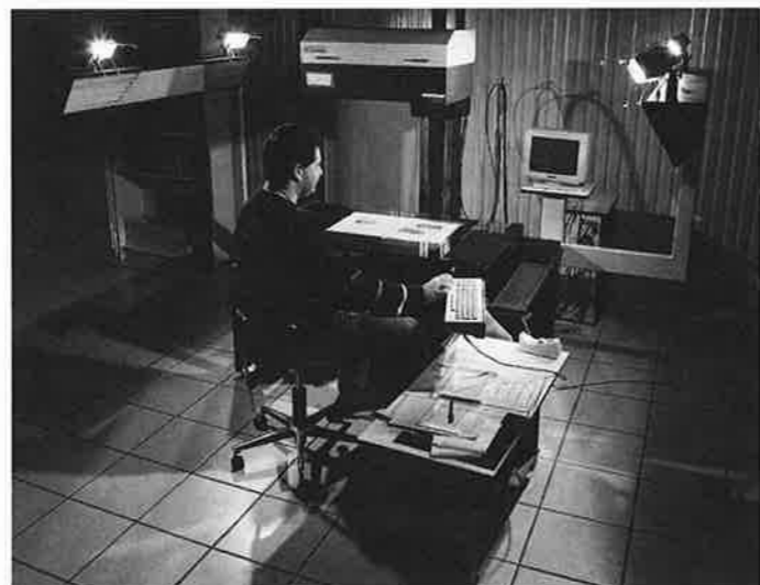
Abb. 1b: Im Hinblick auf die Bestandessicherung werden von jedem Stück der Sammlung Ryhiner durch Farb-Mikroverfilmung zwei Bilder aufgenommen; eines wird als Sicherungskopie gelagert, das andere dem Benutzer zur Einsicht vorgelegt.
