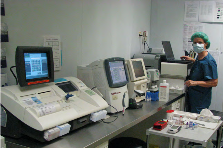
Versuchsaufbau (Tisch von links nach rechts: ABL 825, GEM Premier 4000, GEM Premier 3000; Wagen: HemoCue Hb 201 DM und Hämatokritkapillaren)
