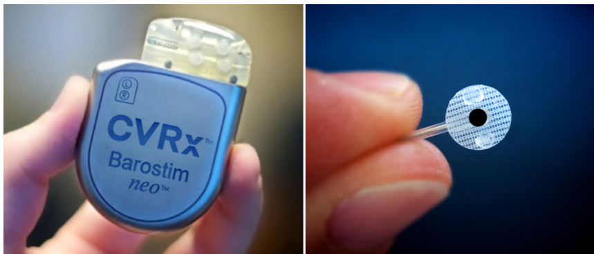
Abb. 3 ▲ Aggregat und Elektrode des Barostim-neo®-Systems. (Fa. CVRx, Inc., Minneapolis, USA, mit freundlicher Genehmigung)
