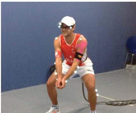
Abb. 1: Experte ausgerüstet mit retro-reflektierenden VICON-Markern und system-integrierter EyeSeeCam in der Verteidigung eines Smash-Angriffsschlages
